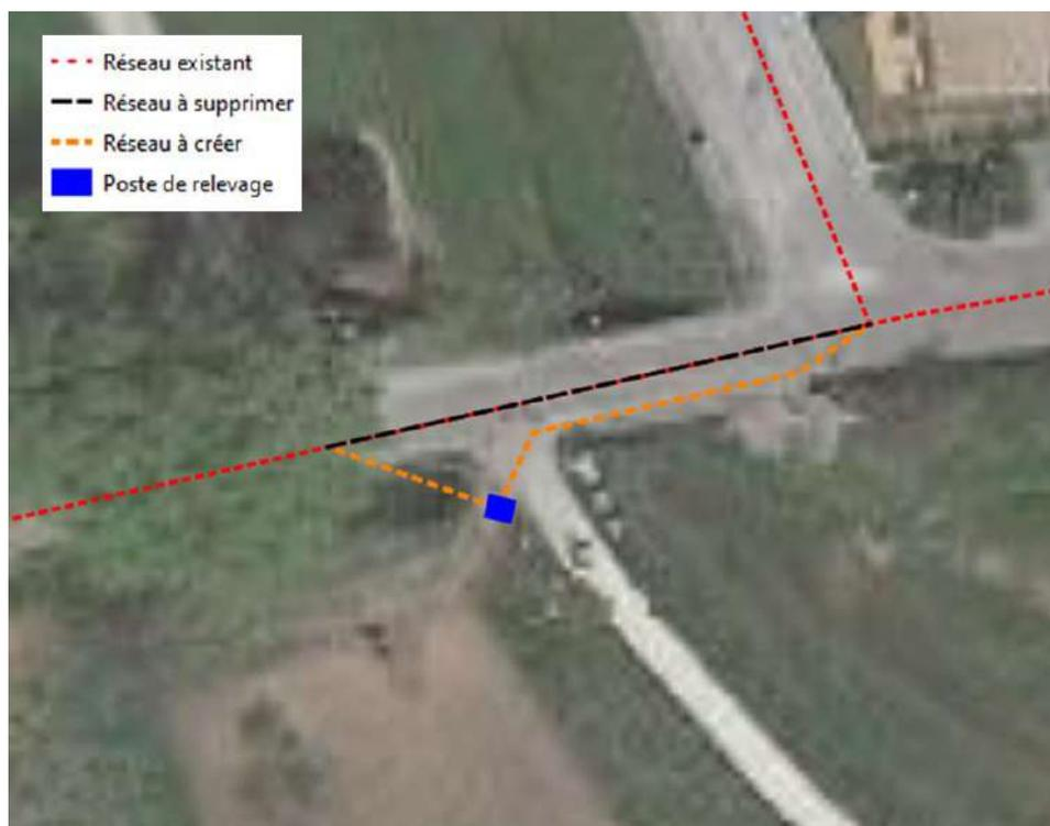
**FIGURE 9 : AMENAGEMENT DU POSTE DE RELEVAGE**
